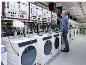
Immagine 1: Test di durata in laboratorio: Miele testa i modelli di apparecchi per una durata di vita fino a 20 anni. (Immagine: Miele)
