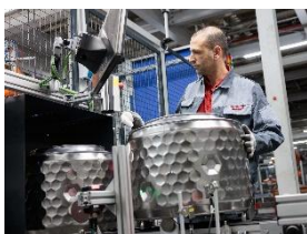
Immagine 5: Un collaboratore Miele controlla il cestello "InfinityCare", il primo al mondo senza centine. (Immagine: Miele)
